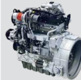
Die Motoren der Baureihe G2 von Doosan erfüllen ohne Dieselpartikelfilter (DPF) alle Euro-Abgasgrenzwerte für Stufe IIIB (55 kW) bzw. IV (74 kW). Für den 74-kW-Motor sind ein Dieseloxydationskatalysator (DOC) und selektive katalytische Reduktionstechnik (SCR) erforderlich. Zusätzliche Wartungsarbeiten, wie Aufbereitungsmaßnahmen oder das Entfernen von Ascheablagerungen, fallen nicht an.
